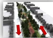
Consolidación de vialidades en eje vial línea verde, Sección tipo: 2.50m de banquetta, 10.00m de arrolló vehicular y camellón central variable. (de 36.00m a 55.00m)
