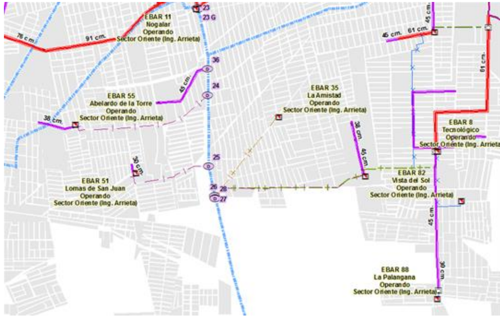
Figura 196. Líneas de impulsión que vierten al Dren 20 de Noviembre
