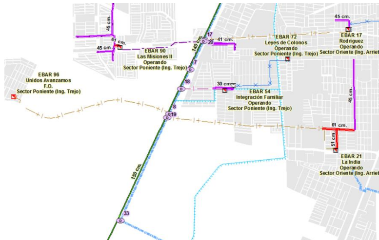
Figura 199. Líneas de impulsión descargando a cuerpos receptores (drenes)
