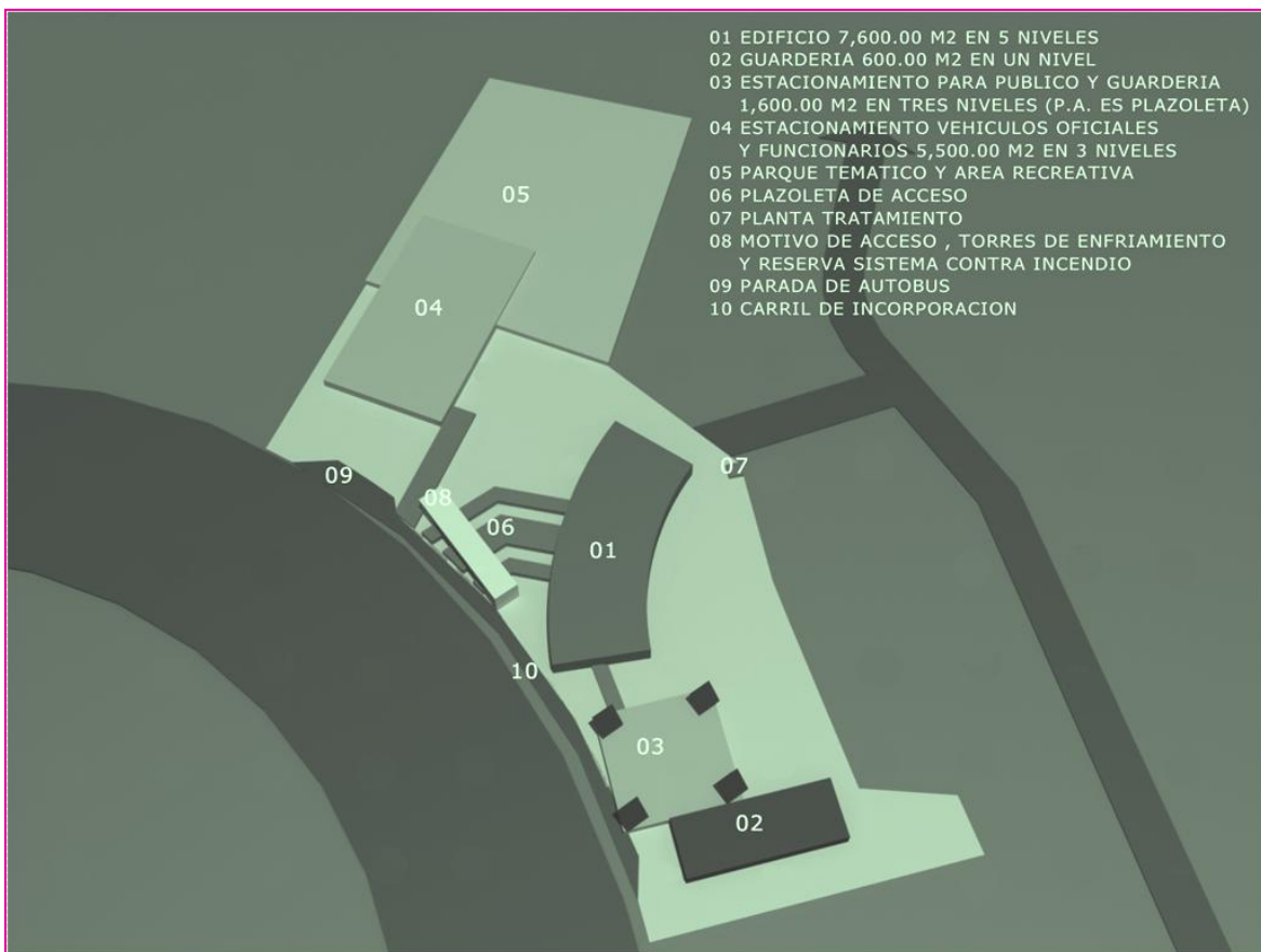
Ilustración 24. Esquema de zonificación del conjunto de elementos que conformarán el proyecto.
