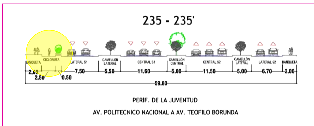
Ilustración 3 Sección vial propuesta en el PDU 2009 de la avenida "Periférico de la Juventud".
