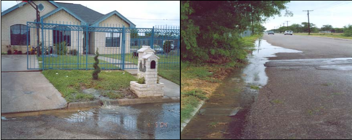
Derrames de drenaje sanitario en zonas habitacionales y calles de la ciudad
