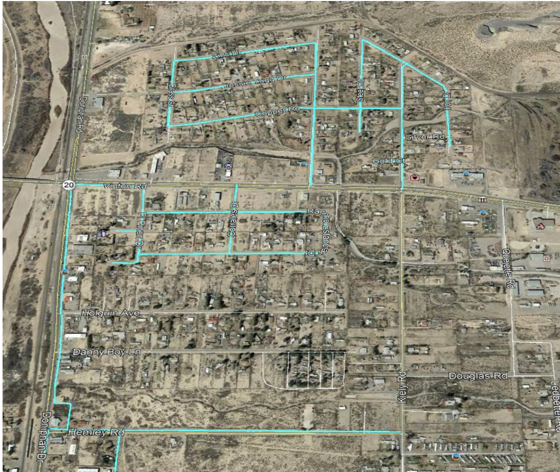
Figura 2 ESQUEMA DE LA ETAPA 1 DEL SISTEMA DE DISTRIBUCIÓN DE AGUA
