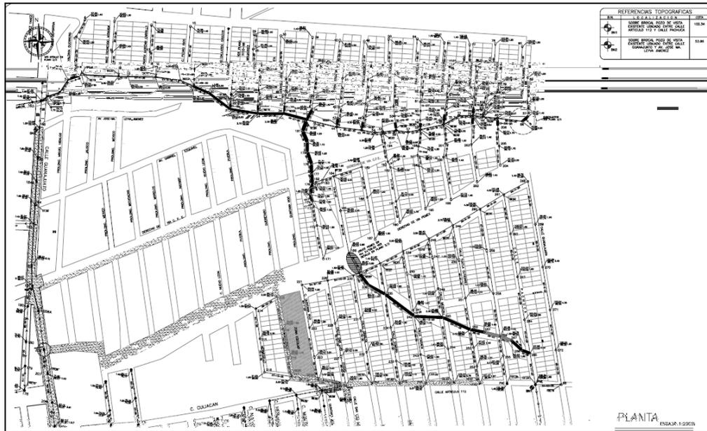
Figura 3.1 Esquema del sistema de alcantarillado para Ampliación Lucio Blanco (2da Etapa)
