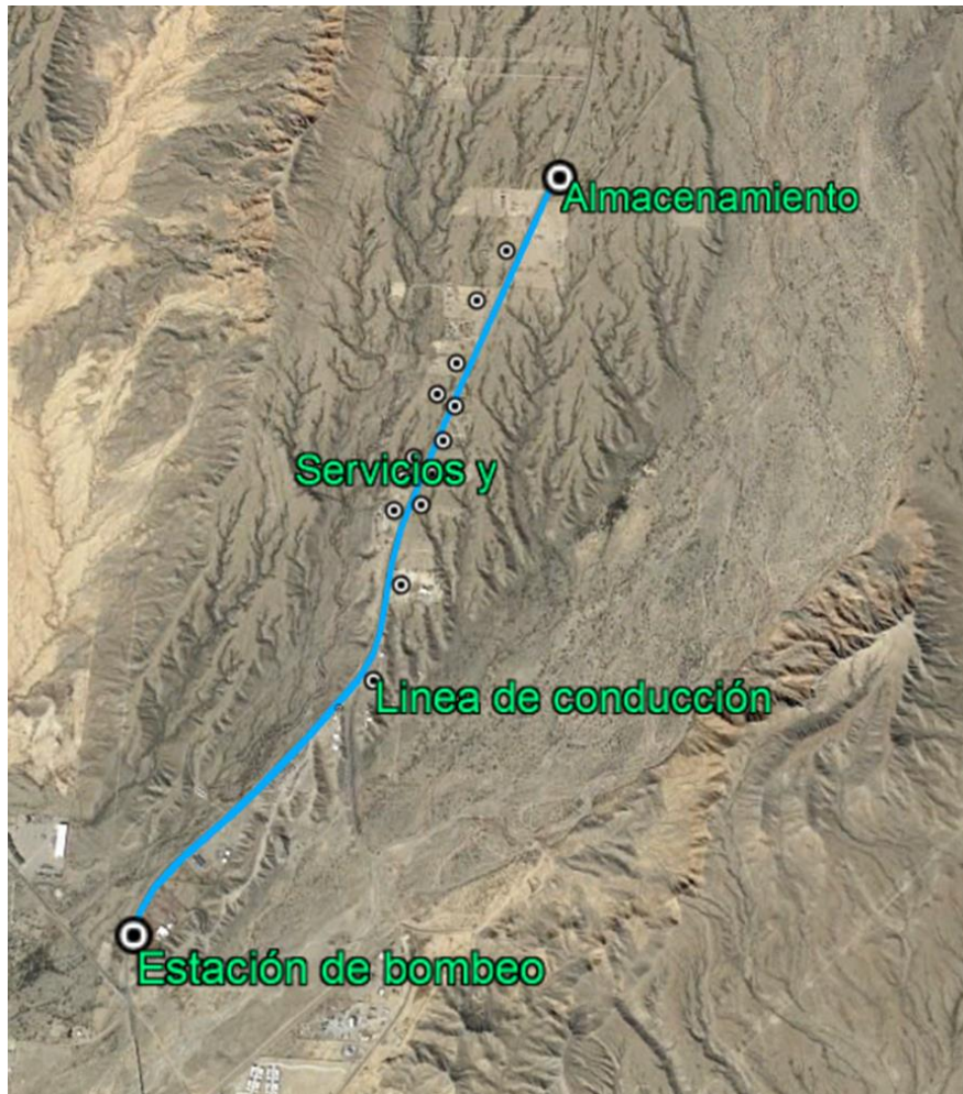
Figura 3 TRAZADO DE LA EXTENSIÓN DE TUBERÍA EN LA CARRETERA 67
